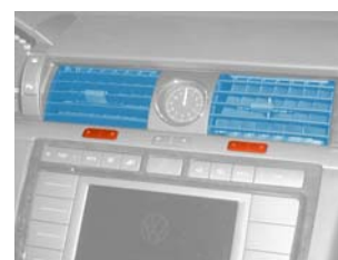
Клавишные переключатели для управления левым E302 и правым E303 дефлекторами в середине передней панели
