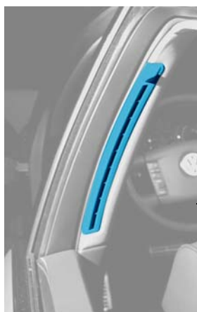
Дефлектор в передней панели, работающий в режиме рассеивающей вентиляции
