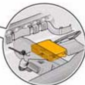
Блок термобиметаллических предохранителей в пространстве для ног, спереди слева
