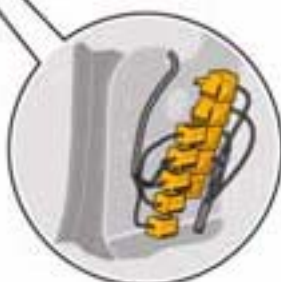
Раздаточные коробки на правой и левой передних стойках кузова
