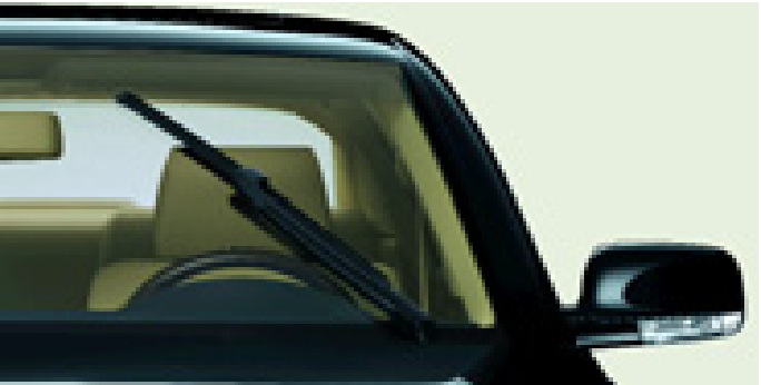
Безопасность пешеходов: в случае столкновения стеклоочистители автоматически опускаются под капот, исключая риск нанесения травмы
