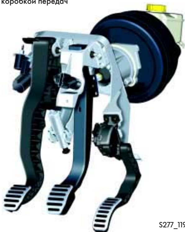
Педальный узел автомобилей с механической коробкой передач
