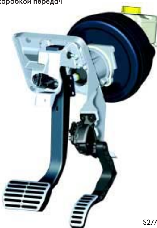
Педальный узел автомобилей с автоматической коробкой передач
