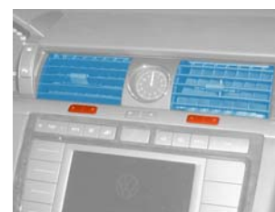
Клавишные переключатели для управления левым Е302 и правым Е303 дефлекторами в середине передней панели
